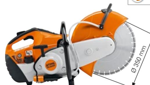
**72,2 cm<sup>3</sup>, 3,9 kW/5,3 CV, 10,2 kg<sup>Ⓞ</sup>.** Para discos de 350 mm. Profundidad de corte hasta 125 mm. La inyección electrónica ofrece un comportamiento óptimo del motor. Conjuntamente con la válvula de descompresión y el sistema de arranque STIHL ElastoStart, el arranque es muy sencillo. Con regulación electrónica para la dosificación de agua. Sistema antivibración STIHL que facilita el manejo. Con motor 2-MIX de bajo consumo.
