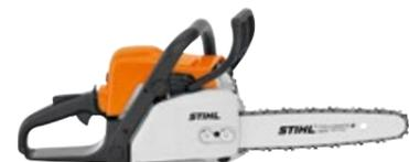
**31,8 cm<sup>3</sup>, 1,4 kW/1,9 CV, 4,1 kg<sup>Ⓞ</sup>**. Modelo básico para cortar leña con más potencia que MS 170 y tensado lateral de la cadena para un tensado seguro y sencillo de la cadena. Versión de 35 cm para cortar ramas más gruesas, motor 2-MIX de bajo consumo.
