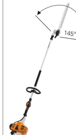
**21,4 cm<sup>3</sup>, 0,75 kW/1,0 CV, 5,9 kg<sup>Ⓞ</sup>**. Para trabajos profesionales en setos altos y para el trabajo a ras del suelo. Máquina ligera, motor 2-MIX con ECOSPEED para regular las revoluciones, STIHL ErgoStart, regulación de cuchilla 145°, longitud total 232 cm.
