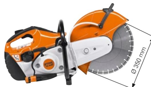
**66,7 cm<sup>3</sup>, 3,2 kW/4,4 CV, 9,7 kg<sup>Ⓞ</sup>.** Con disco de resina sintética de 350 mm para una profundidad de corte de hasta 125 mm. Con sistema antivibración STIHL que facilita el manejo. Sistema de filtro de aire de larga duración. Válvula de descompresión para un arranque más sencillo. Motor 2-MIX de bajo consumo.
