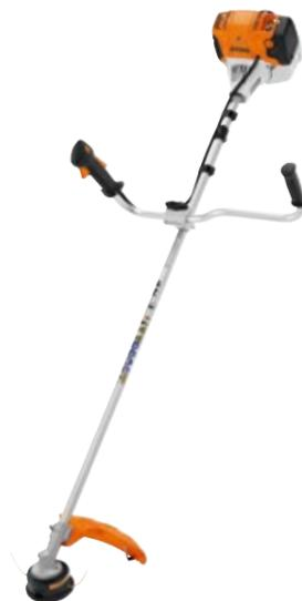
**28,4 cm<sup>3</sup>, 0,95 kW/1,3 CV, 5,8 kg<sup>Ⓞ</sup>.** Para trabajar en superficies con hierba dura. Arranque simplificado, manillar abierto, empuñadura con botón de stop, motor 4-MIX<sup>®</sup>, depósito de combustible de más capacidad. Eje de transmisión rígido.
