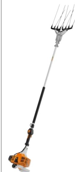
21,4 cm<sup>3</sup>, 0,75 kW/1,0 CV, 5,4 kg<sup>Ⓢ</sup>. Vareador muy ligero con varillas para aceitunas y frutos pequeños. Motor 2-MIX, sistema antivibración STIHL, STIHL ErgoStart, empuñadura de mando con regulación de revoluciones ECOSPEED, arnés, velocidad de varillas regulable, longitud total 231 cm.
