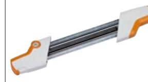
Práctica ayuda para el afilado rápido del diente y del limitador de profundidad en un solo paso. Ideal para usuarios ocasionales. Para cadenas de 1/4" P, 3/8" P, .325", 3/8" y .404, Compensación integrada de tolerancia de lima (exclusivo de STIHL).
