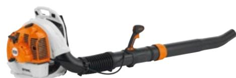
**63,3 cm<sup>3</sup>, 11,5 kg<sup>Ⓞ</sup>**. Soplador muy potente con arranque eléctrico STIHL Elektrostart que permite arrancar la máquina desde la empuñadura. Dispone de cuerda de arranque con STIHL ErgoStart para arranques en temperaturas por debajo de 0°. Con agarre suave, sistema antivibración STIHL, motor 2-MIX con arranque simplificado y gatillo del acelerador regulable con botón de stop. Regulación continua del tubo de soplado. Regulación de la empuñadura sin herramientas.
