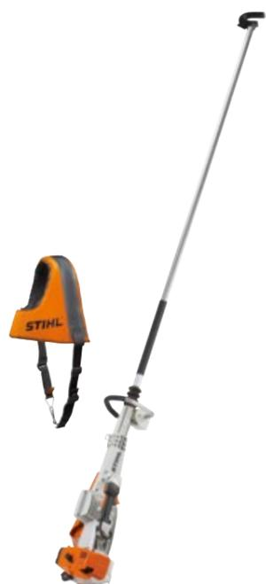
44,3 cm<sup>3</sup>, 2,1 kW/2,9 CV, 13,9 kg<sup>Ⓞ</sup>. Vareador de gancho ligero y eficaz. Buena relación peso/potencia. Con arnés. Longitud total 283 cm.
