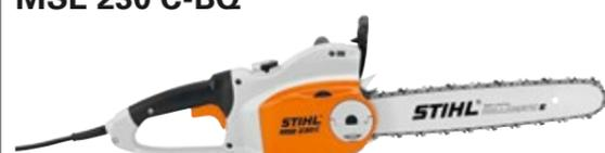
**230 V, 2,3 kW, 4,8 kg<sup>Ⓞ</sup>**. Potente motosierra eléctrica de la última generación. Tensado rápido de cadena, freno de cadena QuickStop Super que detiene la cadena al soltar la empuñadura trasera, empuñadura blanda para un buen agarre e indicador LED de sobrecarga.
