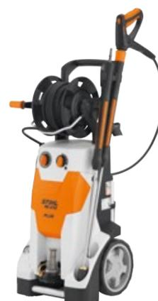
**45–150 bar, 620 l/h, 42,0 kg.** Hidrolimpiadora con un PLUS en comodidad. Motor de bajas revoluciones. Tambor de manguera, 15 m de manguera de alta presión en malla metálica, segunda lanza con boquilla rotativa, pistones con baño cerámico de bajo desgaste. Lanza profesional de STIHL. Depósito de detergente, regulación de presión/caudal, manómetro y filtro de agua.
