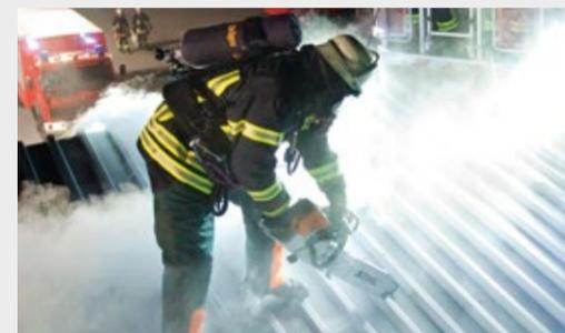
Cadena especial para trabajos exigentes de bomberos, socorristas y protección civil servicios especiales y protección civil (por ejemplo, madera con clavos, materiales compuestos y cristales blindados). Dientes de corte con blindaje completo de placas de metal duro resistentes a los impactos.
