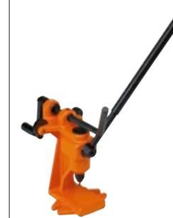
Dispositivo combinado para remachar y abrir remaches de las cadenas.
