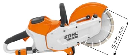
Manejable tronzadora de batería para discos de 230 mm. Se puede utilizar en el interior y en el exterior. Profundidad de corte hasta 70 mm. Conexión de agua con llave de paso y conector de manguera para corte en mojado. Bloqueo del husillo y correa de transmisión sin mantenimiento. Peso 3,9 kg<sup>Ⓞ</sup>.
