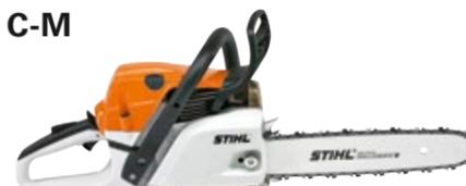
**42,6 cm<sup>3</sup>, 2,3 kW/3,1 CV, 4,5 kg<sup>Ⓞ</sup>**. Elevada potencia del motor con poco peso. M-Tronic de serie. Sistema de filtro de aire de larga duración con filtro HD2 que alarga los intervalos de limpieza, tuerca imperdible en la tapa del piñón de la cadena, motor 2-MIX de bajo consumo, cadena PS de 3/8" para lograr un rendimiento de corte muy elevado.
