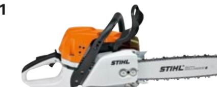
**59,0 cm<sup>3</sup>, 3,1 kW/4,2 CV, 6,2 kg<sup>Ⓞ</sup>**. Para la explotación forestal de arboledas medianas. Sistema de filtro de aire de larga duración para lograr una vida útil del filtro muy larga, motor 2-MIX de bajo consumo y válvula de descompresión para garantizar un arranque más fácil.
