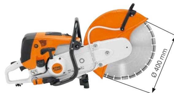
**98,5 cm<sup>3</sup>, 5,0 kW/6,8 CV, 12,7 kg<sup>Ⓞ</sup>**. Para discos de 400 mm. Profundidad de corte 145 mm. Con motor 2-MIX de bajo consumo. Con válvula de descompresión y STIHL ElastoStart que facilita el arranque. Sistema de filtro de aire de larga duración. Se puede acoplar el tren de guía FW 20.
