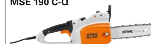
**230 V, 1,9 kW, 4,6 kg<sup>Ⓞ</sup>**. Muy adecuada para construir con madera y para cortar leña. Excelente ergonomía y rendimiento de corte. Freno de cadena QuickStop Super. Cierre de depósito de aceite adhesivo de cadena sin herramientas. Empuñadura blanda para un buen agarre. Protección de sobrecarga.
