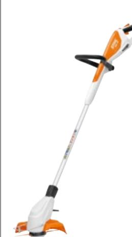
Compacto cortabordes para trabajos sencillos de siega y limpieza en jardines particulares. Batería litio-ión integrada (36 Wh) con indicador de carga. Tubo y manillar ajustable sin herramientas, ángulo de trabajo del cabezal regulable por ejemplo, para cortes de bordes en vertical. Sencillo cambio entre cuchillas PolyCut e hilo. Con distanciador. Peso 2,3 kg<sup>Ⓞ</sup>. Tiempo de carga 145 min / 210 min (80 % / 100 %).
