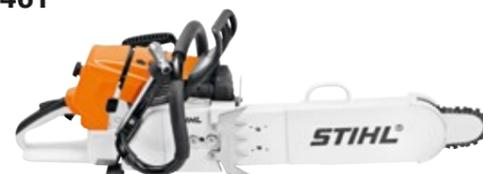
76,5 cm<sup>3</sup>, 4,4 kW/6,0 CV, 7,2 kg<sup>Ⓞ</sup>. Para trabajos de salvamento y lucha contra incendios. Empuñadura adicional para ajustar la profundidad de corte de forma fácil y rápida, gran empuñadura de arranque y válvula de descompresión para arrancar rápida y fácilmente la motosierra, cadena especial con blindaje de placas de metal duro resistente a los impactos.
