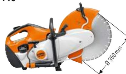
**66,7 cm<sup>3</sup>, 3,2 kW/4,4 CV, 11,1 kg<sup>Ⓞ</sup>**. Tronzadora con regulación de protección más grande y la novedad mundial de STIHL, el freno del disco de corte QuickStop. Para discos de 350 mm. Resulta extremadamente eficiente a la hora de cortar tubos y en lugares de difícil acceso gracias al protector ajustable muy hacia atrás. Equipada con regulación electrónica del agua, sistema de filtrado de larga duración.
