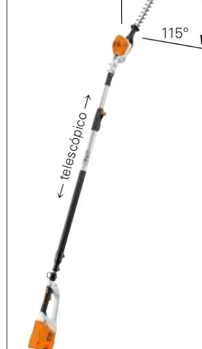
Cortasetos de altura de batería con gran alcance para uso profesional. Con tubo telescópico. Régimen de velocidad en progresión continua. Cuchilla de doble filo regulable 115°. Longitud en posición de transporte 1,80 cm, longitud total 260 – 330 cm, peso 4,4 kg<sup>Ⓞ</sup>. Encontrará más información sobre el equipamiento y los detalles técnicos en la página 183.
