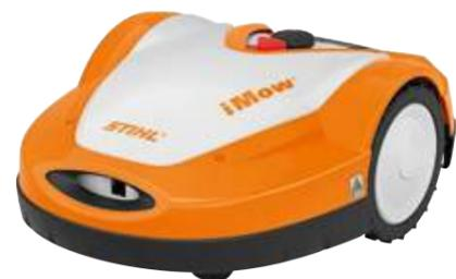
Robot cortacésped totalmente automático para grandes superficies. Corta, desmenuza y abona (como cortacésped para mulching que es) en una sola pasada. Comunicación posible a través de una App. Capacidad de batería de 194 Wh, ancho de corte 28 cm, peso 14 kg<sup>Ⓞ</sup>.
