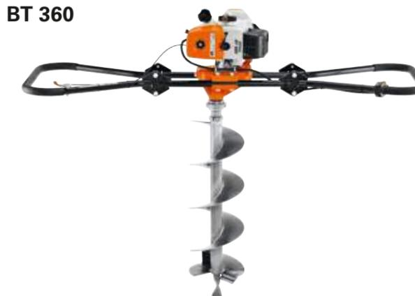
**60,3 cm<sup>3</sup>, 2,9 kW/3,9 CV, 28,8 kg<sup>①</sup>**. Robusta ahoyadora para dos operarios con interruptor adicional de parada para el segundo operario. Equipada con STIHL ElastoStart, bloqueo de arranque y retrogiro, sistema de filtro de aire de larga duración y bastidor plegable.
