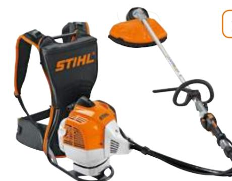
**45,6 cm<sup>3</sup>, 2,2 kW/3,0 CV, 11,4 kg<sup>Ⓞ</sup>.** Ideal para trabajos extensos en arceles y lugares de difícil acceso. Con arranque eléctrico, pulsando un botón, para no tener que quitarse la mochila. Sistema antivibración STIHL, arranque fácil STIHL ErgoStart, empuñadura multifunción, manillar cerrado, motor 2-MIX, gestión electrónica del motor M-Tronic, botón de stop, bolsa de herramientas.
