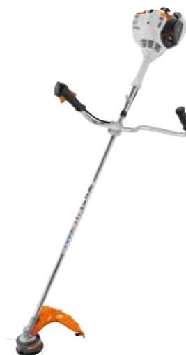
**27,2 cm³, 0,8 kW/1,1 CV, 5,2 kg<sup>Ⓞ</sup>.** Con arranque fácil STIHL ErgoStart. Tubo recto. Con manillar ergonómico y un óptimo ángulo de trabajo para hierba tierna y en superficies lisas. Motor 2-MIX.
