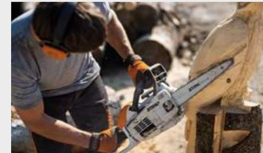
Cadena especial para talladores. Baja en vibraciones, muy buen rendimiento de corte y gracias al rebaje del diente, no es necesario presionar al introducir la espada. Alcanza más velocidad de penetración con las cadenas tradicionales de 1/4".
