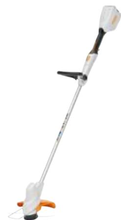
Ligero cortabordes con un potente rendimiento. Diámetro de corte 280 mm. Tubo regulable con un botón y regulación del manillar sin herramientas, agarre suave. El hilo se ajusta automáticamente al golpear ligeramente el cabezal contra el suelo. Peso 2,5 kg<sup>Ⓜ</sup>. Encontrará más información sobre el equipamiento y los detalles técnicos en la página 158.
