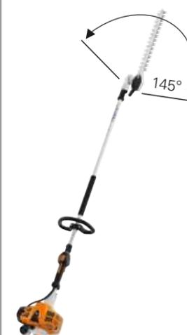
**21,4 cm<sup>3</sup>, 0,75 kW/1,0 CV, 5,9 kg<sup>Ⓞ</sup>.** Para trabajos profesionales en setos altos y para el trabajo a ras del suelo. Máquina ligera, motor 2-MIX con ECOSPEED para regular las revoluciones, STIHL ErgoStart, regulación de cuchilla 145°, longitud total 232 cm.
