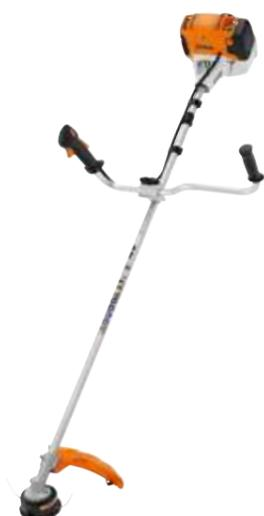
**28,4 cm<sup>3</sup>, 0,95 kW/1,3 CV, 5,8 kg<sup>Ⓞ</sup>.** Para trabajar en superficies con hierba dura. Arranque simplificado, manillar abierto, empuñadura con botón de stop, motor 4-MIX<sup>®</sup>, depósito de combustible de más capacidad. Eje de transmisión rígido.
