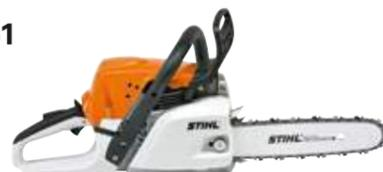
**45,6 cm³, 2,2 kW/3,0 CV, 4,8 kg<sup>Ⓞ</sup>**. Adecuada para la explotación forestal. Tensado lateral de cadena, equipo de corte de .325" robusto y duradero, disponible también con espada de 40 cm para cortar troncos de árboles más gruesos.
