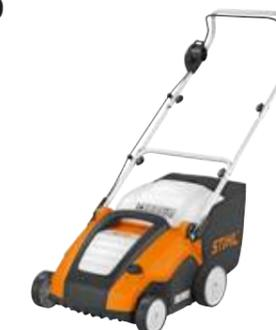
**230 V, 1,5 kW, 16 kg**. Compacto escarificador eléctrico para escarificar y remover superficies poco extensas. Ancho de trabajo 34 cm, 20 cuchillas. Incluye rodillo para airear y recogedor de hierba.
