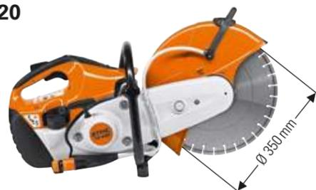
**66,7 cm<sup>3</sup>, 3,2 kW/4,4 CV, 9,7 kg<sup>Ⓞ</sup>**. Tronzadora de uso universal para construcción e ingeniería civil. Con disco de 350 mm para una profundidad de corte de hasta 125 mm. El sistema antivibración STIHL garantiza un buen manejo de la tronadora en el corte. Sistema de filtro de aire de larga duración para una larga vida útil del filtro, arranque con poco esfuerzo gracias a la válvula de descompresión.
