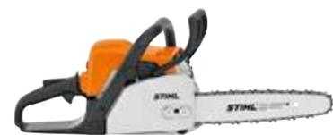
**31,8 cm<sup>3</sup>, 1,4 kW/1,9 CV, 4,1 kg<sup>Ⓞ</sup>.** Modelo básico para cortar leña con más potencia que MS 170 y tensado lateral de la cadena para un tensado seguro y sencillo de la cadena. Versión de 35 cm para cortar ramas más gruesas.
