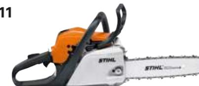
**35,2 cm<sup>3</sup>, 1,7 kW/2,3 CV, 4,3 kg<sup>Ⓞ</sup>.** Adecuada para cortar leña. Tensado lateral de cadena, selección de modo verano o modo invierno para un buen comportamiento en cualquier condición climática, cadena PM3 de 3/8" para un buen rendimiento de corte.
