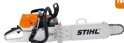
**72,2 cm<sup>3</sup>, 4,4 kW/6,0 CV, 6,5 kg<sup>Ⓞ</sup>**. Para trabajos de salvamento y lucha contra incendios. Tensado rápido para una fijación sencilla de la profundidad de corte, M-Tronic para garantizar siempre un rendimiento óptimo de la motosierra, filtro HD2 con un excelente filtrado. Gran empuñadura y válvula de descompresión para un arranque sencillo y seguro, cadena especial con blindaje de placas de metal duro resistentes a los impactos.
