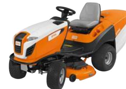
**656 cm<sup>3</sup>, 8,7 kW/11,8 CV, 263 kg<sup>Ⓞ</sup>.** Potente tractor cortacésped con extraordinaria comodidad de conducción y manejo. Para el cuidado de superficies muy extensas. Con la tracción de 1 pedal específica de STIHL y recogedor de hierba de 350 litros.
