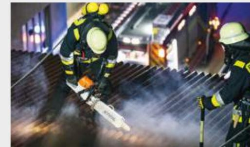
Cadena especial para trabajos exigentes de bomberos, servicios especiales de protección civil (por ejemplo, madera con clavos, materiales compuestos y cristales blindados). Dientes de corte con blindaje completo de placas de metal duro resistentes a los impactos.
