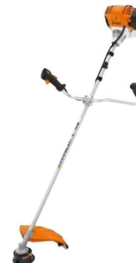
**28,4 cm³, 0,95 kW/1,3 CV, 5,8 kg<sup>Ⓞ</sup>.** Para trabajar en superficies con hierba dura. Arranque simplificado, manillar abierto, empuñadura con botón de stop, motor 4-MIX<sup>®</sup>, depósito de combustible de más capacidad. Eje de transmisión flexible.
