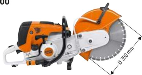
**98,5 cm³, 5,0 kW/6,8 CV, 11,7 kg<sup>①</sup>**. La más potente de las tronadoras para discos de 350 mm. Esta tronadora se adecua a la perfección para su uso a la profundidad de corte total y también sobre el tren de guía FW 20. Está equipada con válvula de descompresión y con STIHL ElastoStart para un arranque con menos esfuerzo y con el sistema de filtro de aire de larga duración para una prolongada vida útil del filtro.
