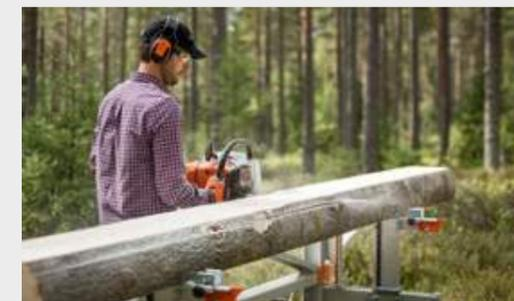
Cadena de corte longitudinal especial para la aplicación en equipos de corte longitudinal para la realización de tableros, así como en mecanismos móviles de sierras pequeñas. Cadena de dientes de tipo semicincel con alta calidad de corte y bajas vibraciones, además de un comportamiento de corte suave.
