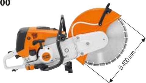
**98,5 cm³, 5,0 kW/6,8 CV, 12,7 kg<sup>①</sup>**. Tronadora STIHL para discos de 400 mm. Profundidad de corte máxima de 145 mm, peso reducido gracias al protector de magnesio. Perfectamente adecuada para ranuras de dilatación sobre el tren de guía FW 20. Equipada con válvula de descompresión y STIHL ElastoStart para un arranque sencillo y con el sistema de filtro de aire de larga duración para una elevada vida útil del filtro.
