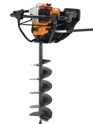
**36,3 cm<sup>3</sup>, 1,4 kW/1,9 CV, 10,0 kg<sup>①</sup>**. Ahoyadora para un solo operario con freno de barrena QuickStop. Motor 4-MIX®. Depósito con mayor capacidad. Vibraciones amortiguadas en el manillar. Manillar con botón de stop. Sistema de filtro de aire de larga duración. Gran apoyo acolchado.
