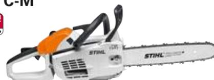
**35,2 cm<sup>3</sup>, 1,8 kW/2,4 CV, 3,9 kg<sup>①</sup>**. La motosierra profesional más ligera de STIHL, ideal para trabajos de poda. M-Tronic de serie para una potencia de motor siempre óptima, arranque fácil gracias a una sola posición de arranque. Tuerca imperdible en la tapa del piñón de la cadena, cadena PS de 3/8" para lograr un elevado rendimiento de corte.
