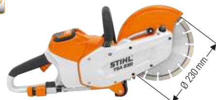
Manejable tronadora de batería para discos de 230 mm. Se puede utilizar en el interior y en el exterior. Profundidad de corte hasta 70 mm. Conexión de agua con llave de paso y conector de manguera para corte en mojado. Bloqueo del husillo y correa de transmisión sin mantenimiento. Peso 3,9 kg<sup>Ⓞ</sup>. Encontrará más información sobre el equipamiento y los detalles técnicos en la página 256.
