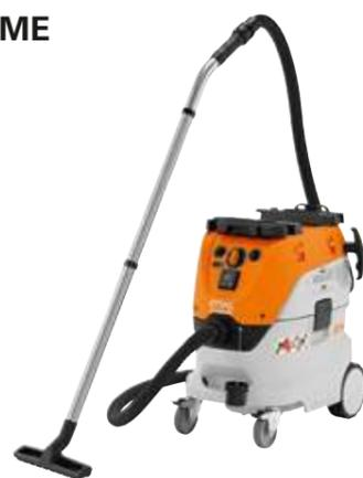
**1,4 kW, 250 mbar, 4.500 l/min.** Potente aspiradora de líquidos y sólidos con encendido automático de la clase de polvo M. Limpieza de filtro automática sin pérdida de potencia de aspiración, monitorización automática del caudal volumétrico, ajuste en progresión continua del régimen de revoluciones, con adaptadores para alojar cajas de herramientas, accesorios antiestáticos aptos también para limpiar herramientas de batería y eléctricas.
