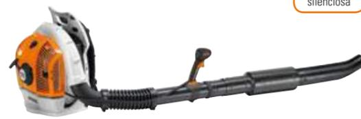
**64,8 cm³, 10,1 kg**®. Medidas activas como el motor 4-MIX® y medidas pasivas como el silenciador integrado, reducen claramente el nivel de ruido. Por tanto, especialmente adecuado para trabajos de limpieza en zonas sensibles al ruido. Agarre suave. Sistema antivibración STIHL. Gatillo del acelerador regulable con botón de stop. Arnés de correas ergonómicas y anchas.
