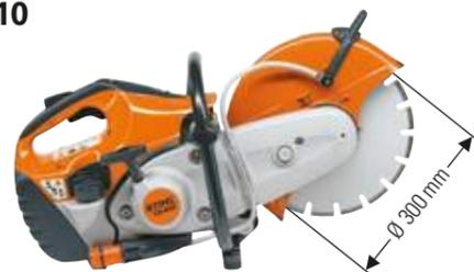
**66,7 cm<sup>3</sup>, 3,2 kW/4,4 CV, 9,5 kg<sup>Ⓞ</sup>**. Tronzadora ligera y manejable. Con disco de 300 mm para cortes de hasta 100 mm de profundidad. El sistema antivibración STIHL garantiza un buen manejo de la tronadora en el corte. Sistema de filtro de aire de larga duración para una larga vida útil del filtro, arranque con poco esfuerzo gracias a la válvula de descompresión.
